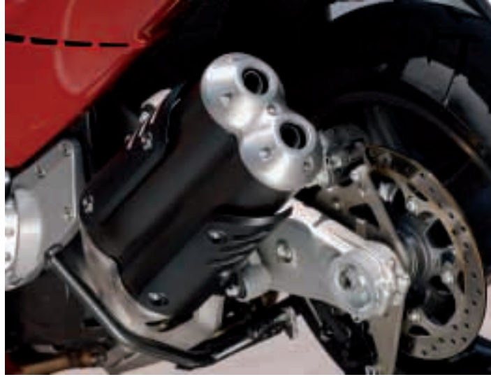
Um Vibrationen zu verringern ist die Auspuffanlage vom Rahmen entkoppelt
