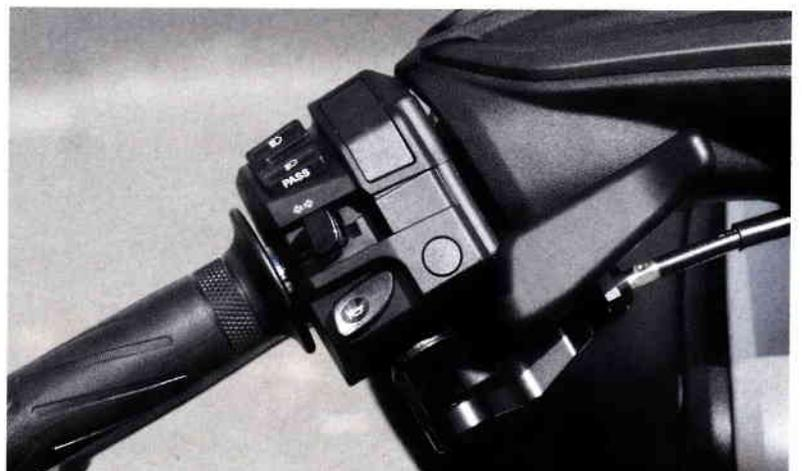
*Die Insignien des Max: Tief liegende Analoguhren mit LC-Display und eine beeindruckende Lenkereinheit samt Feststellbremse, aber ohne Tempomat-Wippschalter (Blinddeckel). Trittbrettauflagen aus Alu finden sich bei allen TMAX-Versionen.*
