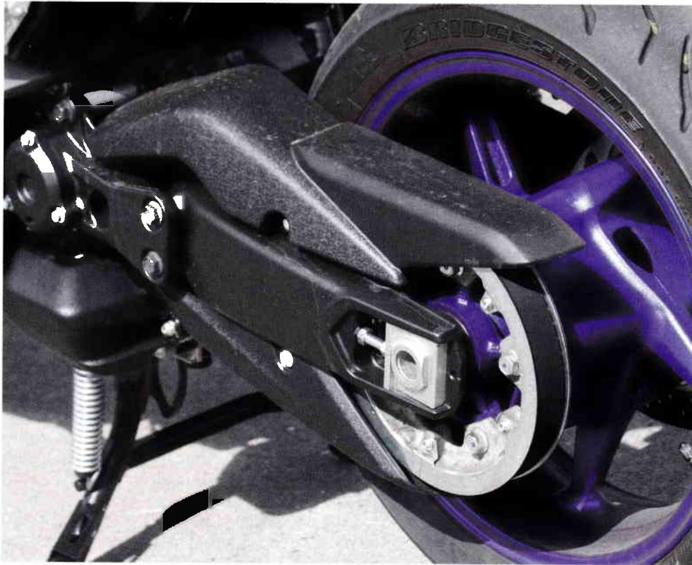
*Beleuchtet und schluckfreudig: Die Sitzbank öffnet nach hinten und erlaubt den Zugang zum erstaunlich großen Staufach. Der breite Zahnriemen nimmt es locker mit der Leistung des Reihen-zweizylinders auf, ein hochwertiger Spannmechanismus unterstreicht die Wertigkeit des Maxis.*
